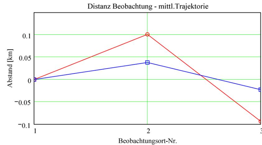
Abweichung der vermessenen Richtungen zu den Anfangs- und Endpunkten von der berechneten mittleren Trajektorie.
